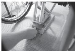
Poussez l'outil de déverrouillage d'urgence et le fauteuil roulant électrique vers l'avant jusqu'à ce que la goupille de verrouillage soit forcée vers le bas.
