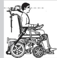
Le « mannequin de simulation d'impact » était retenu par une ceinture de maintien pelvienne et une ceinture-baudrier. Ces deux types de ceinture de sécurité doivent être utilisés pour réduire les risques de blessures à la tête ou au torse.
