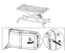
Appuyez sur les deux verrous (A) du boîtier de contrôle à l'aide d'un objet pointu (tournevis, par exemple) et ouvrez le couvercle.
