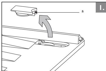
Drücken Sie den roten Saugerdeckel von der Unterseite der Grundplatte aus dem Schlüsselloch.
