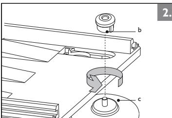
Stecken Sie den Adapter (b) in die Grundplatte (Öffnung zeigt zur vorderen Ecke). Schrauben Sie den Sauger (c) von unten in den Adapter und halten diesen dabei fest.
