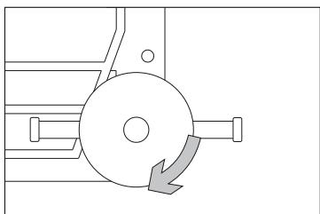
Schrauben Sie die hinteren Sauger im Uhrzeigersinn von unten in die Mutter.
