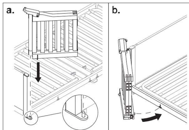
Coloque la barandilla en el pasador del chasis del extremo de la cama y ciérrela, de modo que embrague en el tubo cuadrado lateral de la plataforma del somier con un chasquido audible.
