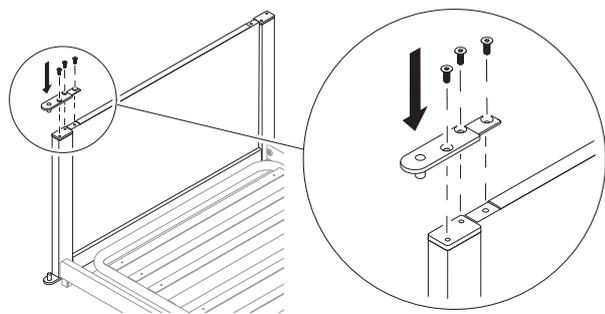
En un lado de la cama, instale temporalmente la placa para fijar el panel del extremo de la cama al chasis del extremo de la cama hasta que se haya montado una barandilla en el otro lado de la cama.
