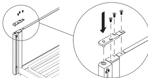
Fije el pilar y el panel del extremo de la cama con la placa y los tres tornillos.
