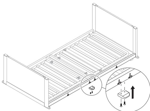
Fije la cuña central con dos tornillos en la parte inferior del tubo cuadrado lateral de la plataforma del somier.
