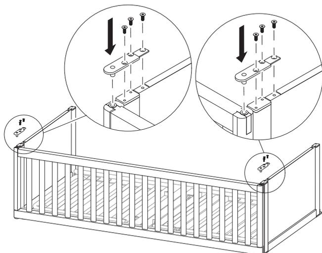
En ambos extremos de la cama, fije la barandilla y los paneles de los extremos de la cama con la placa y los tres tornillos.
