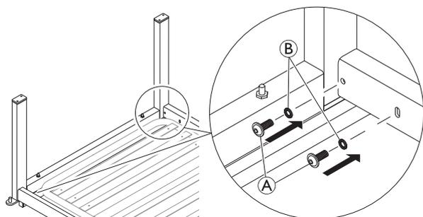
A ambos lados de la cama, introduzca los tornillos (A) con sus arandelas (B) y apriételes hasta que el chasis del extremo de la cama esté estable pero aún tenga un ángulo ligeramente ajustable.
