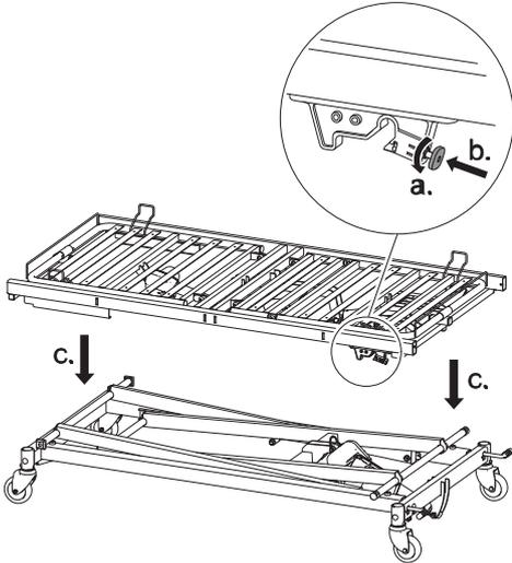
A ambos lados de la plataforma del somier, gire el pasador de bloqueo rojo 45° en el sentido contrario a las agujas del reloj y déjelo que encaje en su posición bloqueada antes de bajar la plataforma del somier sobre el mecanismo de elevación.
