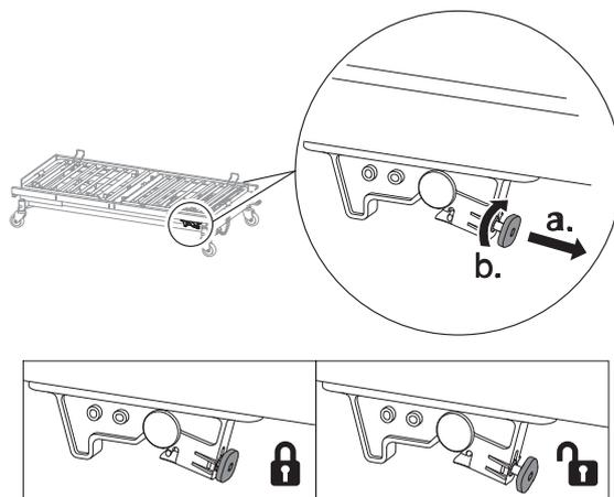
A ambos lados de la plataforma del somier, tire del pasador de bloqueo rojo y gírelo 45° en el sentido de las agujas del reloj para fijarlo en la posición desbloqueada.
