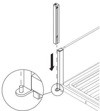
Coloque el pilar en el pasador de los chasis de los extremos de la cama con la guía orientada hacia el otro extremo de la cama.
