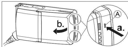
Para abrir la unidad de control: Presione los dos pestillos (A) en la unidad de control con un objeto puntiagudo (por ejemplo, un destornillador) y abra la tapa.
