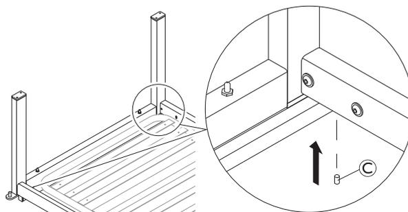
Coloque el chasis del extremo de la cama en un ángulo de 90° con respecto a la plataforma del somier y, en ambos lados de la cama, introduzca el tornillo sin cabeza (C) hasta sentir resistencia.
