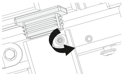
II) Gire el tornillo de ajuste en ángulo dentro del tubo del chasis superior de la cama para cambiar el ángulo.
