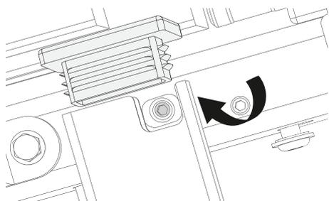
III) Apriete el tornillo sin cabeza hasta que sienta resistencia para bloquear el ángulo por completo.
