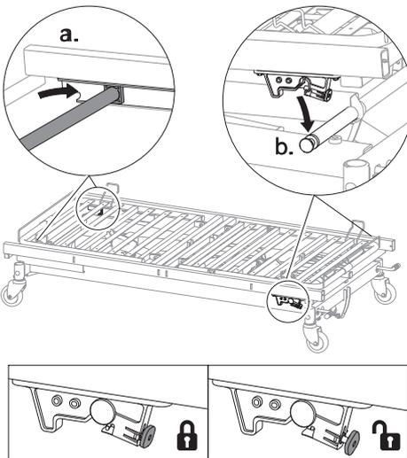
En el extremo de la cabecera, deslice los bloques deslizantes del mecanismo de elevación en las guías de la plataforma del somier y en el extremo de los pies baje la plataforma del somier sobre el mecanismo de elevación hasta que encaje con un clic audible.
