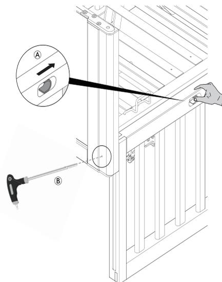
I) Empuje un pestillo con una mano (A) e introduzca una herramienta de Allen de 3 mm a través del orificio del pilar con la otra (B) para retraer el tope del émbolo.
