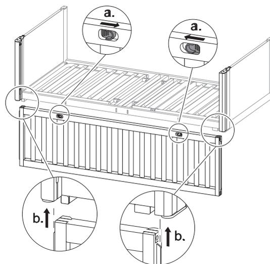
Empuje y mantenga los dos pestillos uno hacia el otro y deslice la barandilla en las guías de los pilares desde abajo.
