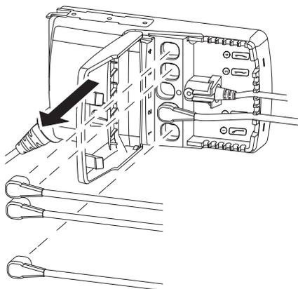
Desenchufe los cables de los pistones de las secciones del colchón de la unidad de control y cierre la tapa de la unidad de control.
