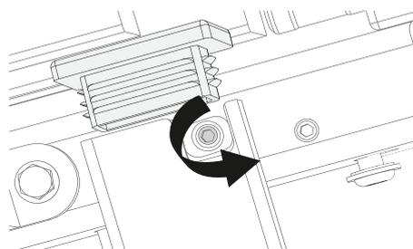
I) Gire el tornillo de ajuste en ángulo dentro del tubo del chasis superior de la cama para ajustar el espacio entre el extremo de la cama y la barandilla.
