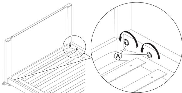
Afloje ligeramente los tornillos A de cada esquina, de modo que los chasis de los extremos de la cama se mantengan estables pero permitan ajustar ligeramente el ángulo.
