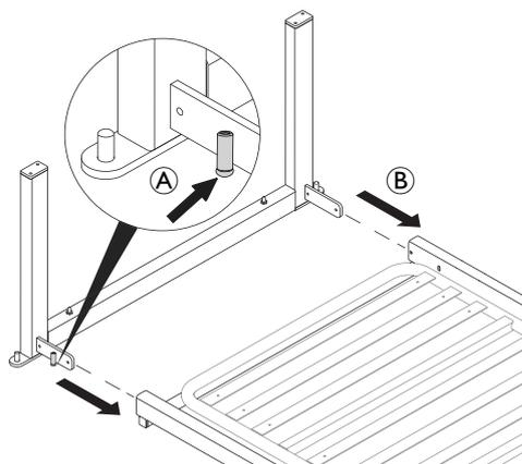
Introduzca los conectores del chasis del extremo de la cama en los tubos cuadrados laterales de la plataforma del somier (B).
