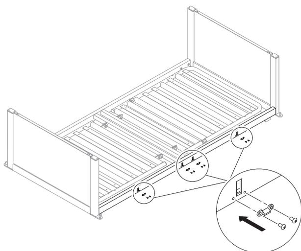
Fije una cuña pequeña con dos tornillos debajo de cada una de las cuatro ranuras del tubo cuadrado lateral de la plataforma del somier.
