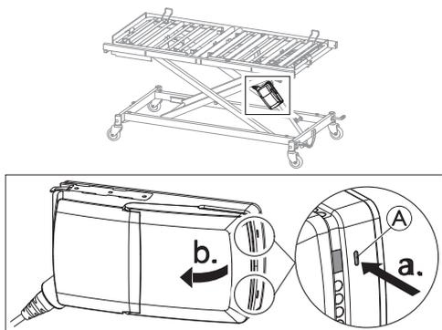
Presione los dos pestillos **A** en la unidad de control con un objeto puntiagudo (por ejemplo, un destornillador) y abra la tapa.
