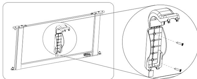
Instale la caja del mando en el extremo de la cama del lado de los pies apretando los tornillos.
