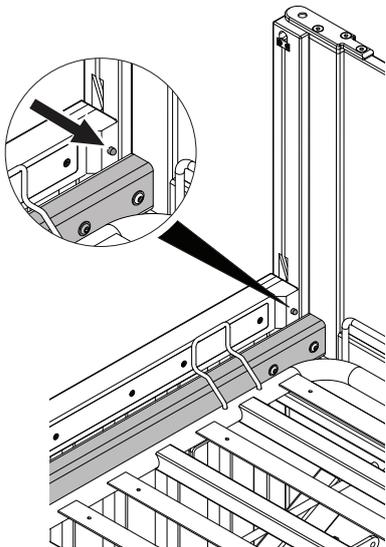
I) Empuje y sostenga los dos pestillos y baje la barandilla hasta que el tope del émbolo toque la plataforma del somier.
