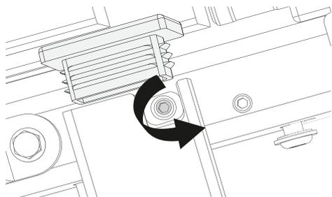
II) Cuando alcance el ángulo correcto, gire el tornillo de ajuste en ángulo dentro del tubo del chasis superior de la cama para ajustar el espacio entre el extremo de la cama y la barandilla.
