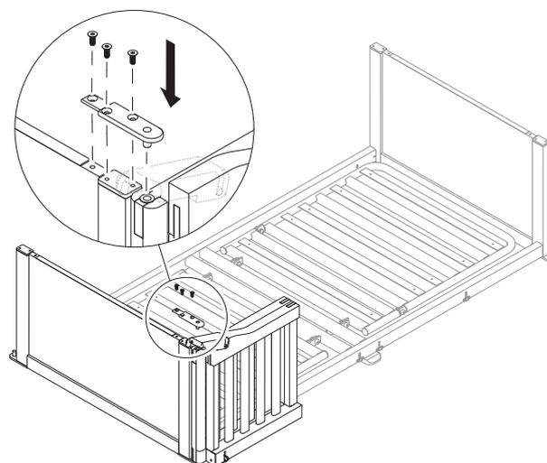
Fije la barandilla y los paneles de los extremos de la cama con la placa y los tres tornillos.
