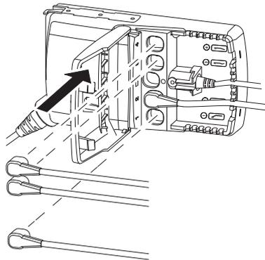
Enchufe los cables de los pistones de la sección del colchón y cierre la tapa de la unidad de control.
